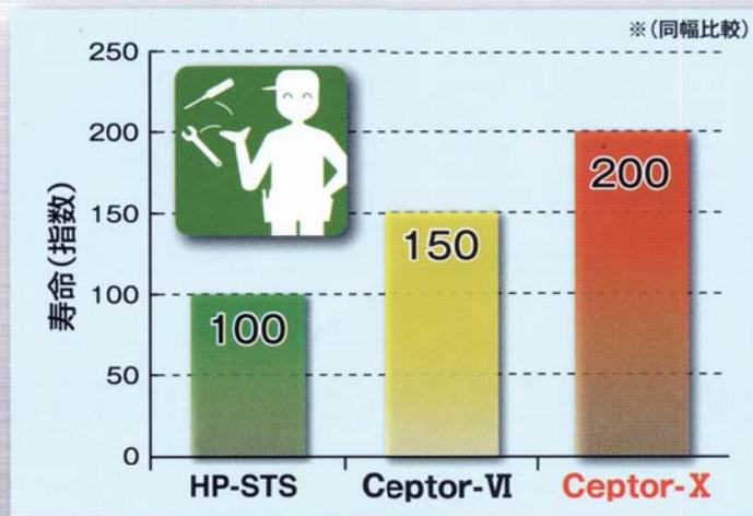
高弾性心線の採用によりベルト伸びが小さく、また帆布表面処理により耐摩耗性が向上し、従来のベルトと比較すると約1.8~2.0倍の耐久性を有しております。
